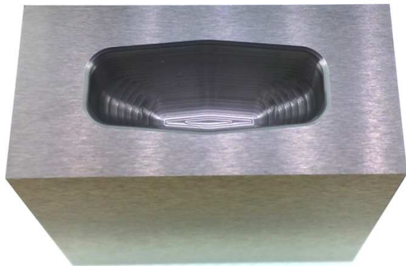
工件尺寸 : 40 x 20 x t 40 mm 加工尺寸 : 27.0 x 11.8 (上面) 深度 10.5 mm
