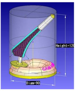
・工件尺寸 : \$\phi90 mm x 120 mm
