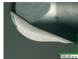
条件3 4ポケット加工後の工具状態
