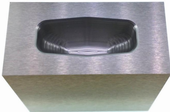
ワークサイズ : 40 x 20 x t 40 mm モデルサイズ : 27.0 x 11.8 (上面) 深さ 10.5 mm
