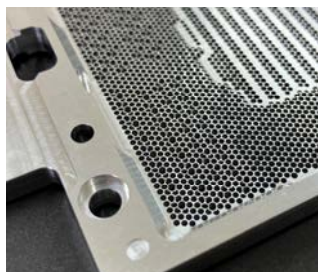
アルミA6061（6,000穴加工） 穴径： \phi 0.8\text{mm} 板厚：0.1mm
