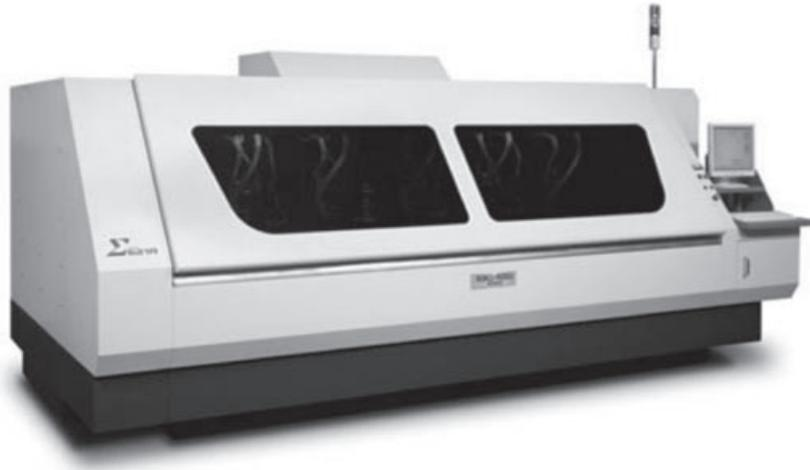
図 9-9 電子回路基板外形加工機（碌々産業）
