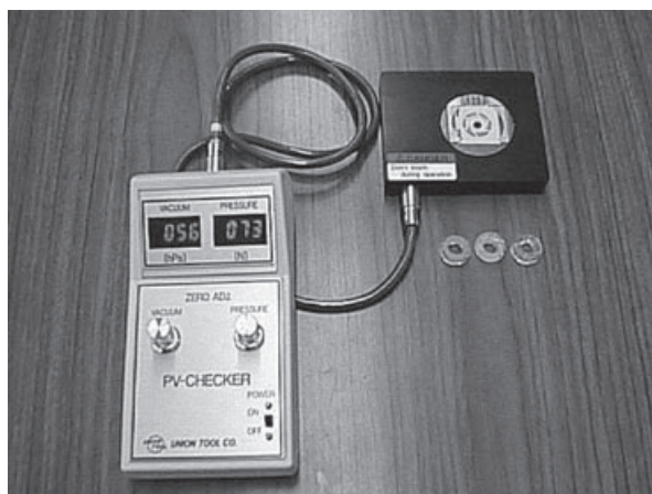
図 4-11 バキューム圧力、先端ブッシュ面圧測定器 (PVチェッカー)
