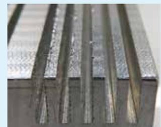
溝加工 : 80溝 (切削距離 160m)
